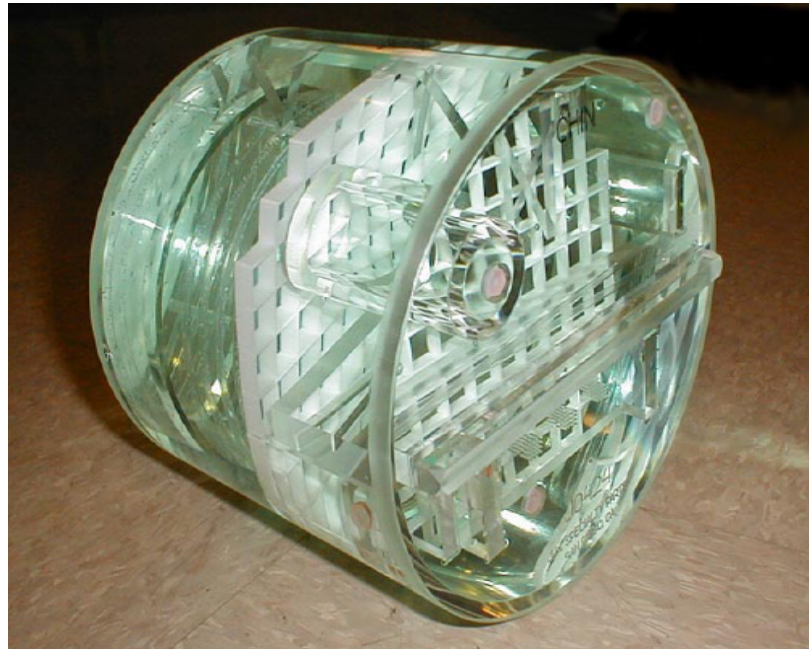
Maniquí propuesto por la ACR para el control de calidad en IRM
